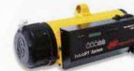
Capacidades hasta 1.000 lb. IntelLIFT elimina la necesidad de los interruptores de ascenso y descenso y permite operaciones completamente manuales, detectando la fuerza ejercida por el usuario traduciendo en ascensos y descensos precisos. Con modo de flotación en todo el intervalo de movimiento. Se usa en aplicaciones: - Que requieren posicionamiento de precisión. - Donde se requiere o prefiere el control activo de cargas. - Donde se prefiere la operación con una mano.
