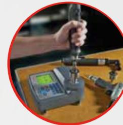
Los medidores de par de la serie EXTT proporcionan un método rápido y fácil de configurar y calibrar herramientas de atornillado de precisión de par bajo, incluidos atornilladores, aprietatuercas y herramientas de impulso. El medidor EXTT es una unidad de banco que funciona con batería y puede montarse en un depósito de herramientas o laboratorio de calibración, o colocarse en una carretilla móvil y llevarlo al lugar de la aplicación.
