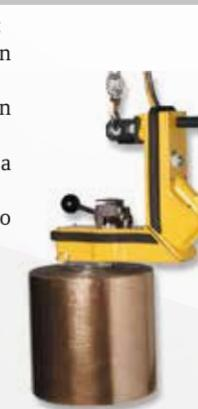
Se usa en aplicaciones con: -Piezas cilíndricas con un orificio accesible en el núcleo. -Transferencia o manipulación directa de piezas. -Piezas habituales rollos y piezas mecanizadas.
