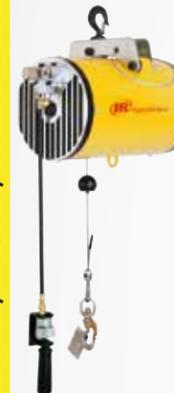
Capacidades hasta 2.000 lb. Permite al usuario mover cargas con controles de elevación/bajada y luego con el modo de flotación que permite el movimiento y la colocación manual de precisión de la carga sin las "sacudidas" asociadas con los polipastos neumáticos y eléctricos. Ahorro de energía; menos consumo de aire que un polipasto neumático. Se usa en aplicaciones que necesitan posicionamiento de precisión. Ofrece recorridos hasta 120".
